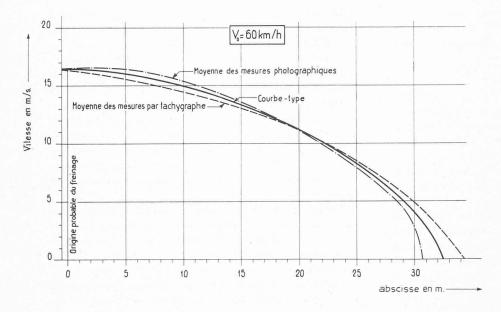
Fig. 1. — Valeur de la vitesse durant le freinage en fonction du chemin parcouru, courbe type v = f(s).
