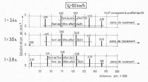
Fig. 5. — Détermination de l'effort de freinage maximum.
