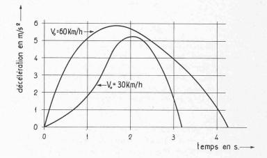
Fig. 4. — Valeur de la décélération durant le freinage en fonction du temps : a=f(t).
