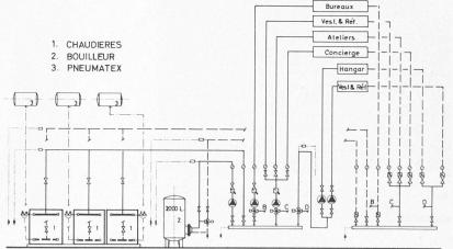
Fig. 1. — Schéma de principe.
