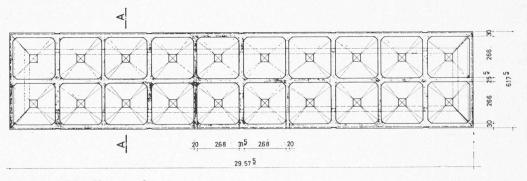
Fig. 7. — Silo. Vue en plan.
