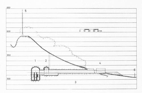
Fig. 1. — Profil en long de la centrale nucléaire expérimentale de Lucens. 1. Caverne du réacteur. 2. Caverne des machines. 3. Galerie d'accès. 4. Bâtiment de service. 5. Poste météorologique du sommet de la cheminée. 6. Poste météorologique du mât.
