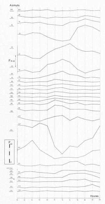
Fig. 7. — Fréquences des directions du vent à la cheminée, en fonction de l'heure.
