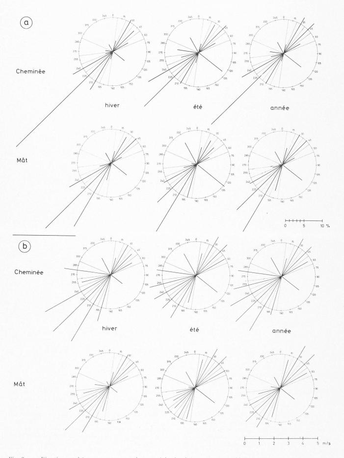
Fig. 3a. — Directions et fréquences moyennes du vent, à la cheminée et au mât, en hiver, en été et pour l'année. Fig. 3b. — Directions et vitesses moyennes du vent, à la cheminée et au mât, en hiver, en été et pour l'année.
