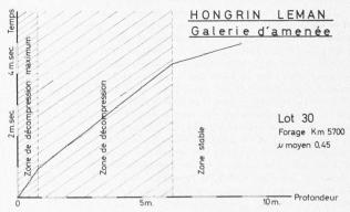
Fig. 5. — Détermination de l'épaisseur de la zone de décompression radiale d'une galerie d'amenée. La zone de décompression atteint ici 6 m.
