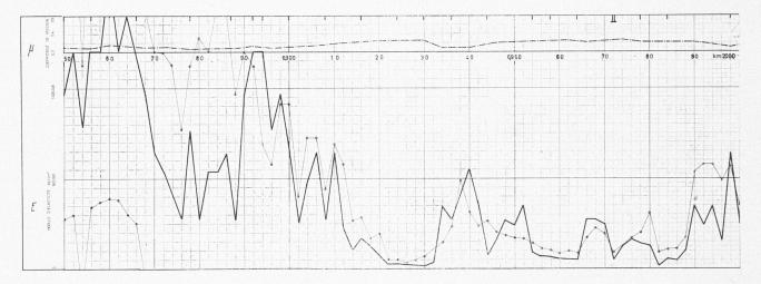
Fig. 4. — Détermination par mesures sismiques du module d'élasticité et du coefficient de Poisson sur les deux parements d'une galerie d'amenée. — Le passage Malm (calcaire très compact) - Néocomien (calcaire marneux) se produit au km 69 environ.
