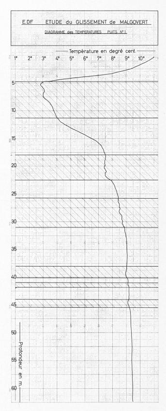
Fig. 9. — Zones d'écoulement correspondant à des zones de glissements (hachurées). Etude réalisée pour l'EDF à Malgovert.
