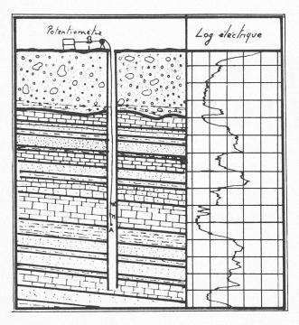
Fig. 1. — Diagraphie électrique.
