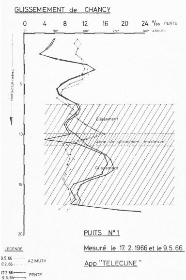
Fig. 7. — Localisation du plan de glissement principal à Chancy. Etude réalisée avec l'inclinomètre Télécline.
