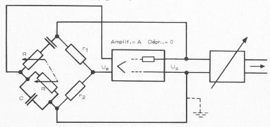
Fig. 5. Schéma de l'oscillateur (Emetteur).
