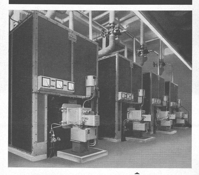
pour eau surchauffée et eau chaude jusqu'à une pression de service de 20 kg/cm² et puissances thermiques de 0,5 à 10 millions kcal/h, convenant pour la combustion de mazout, de charbon non frittant, de coke, de bois, de déchets et de gaz d'éclairage.
