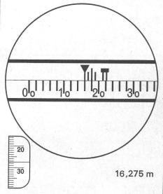
Ce stadimètre à double image, d'une construction des plus modernes, est l'instrument approprié à la mensuration cadastrale. La lecture des distances est particulièrement simple, grâce à l'absence de vernier sur la mire. Un prisme additionnel permet la correction de l'erreur personnelle. Erreur moyenne des distances sur 100 m:
