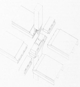
Fig. 13. — Schéma de la rencontre des éléments de structure.
