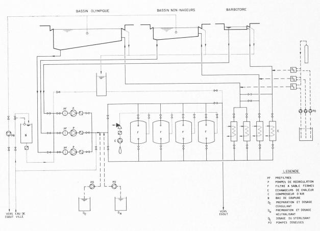
Fig. 6. — Traitement de l'eau — Schéma simplifié.
