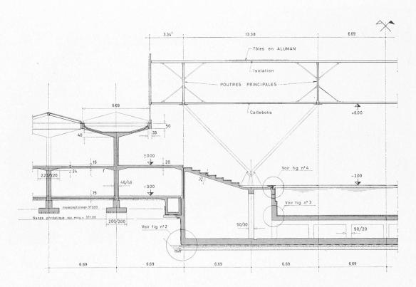
Fig. 1. — Coupe générale montrant à gauche une partie de la zone des vestiaires et de l'administration et à droite une partie de la zone de la piscine.
