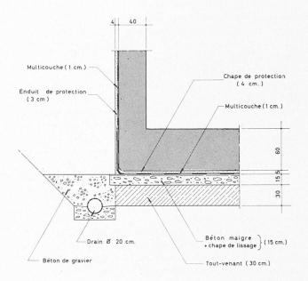
Fig. 2. — Coupe détaillée du sous-radier et du radier.
