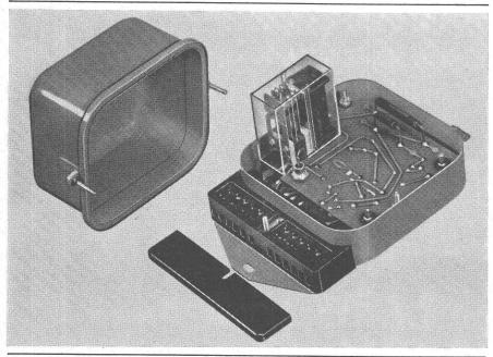
Le relais TSU est un composant universel pour la surveillance d'une grande gamme de tensions en courant continu ou alternatif.
