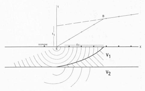
Fig. 3. — Modèle de réfraction sismique.
