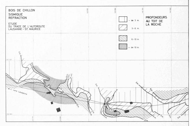
Fig. 4. — Etude sismique des bois de Chillon (partie ouest).
