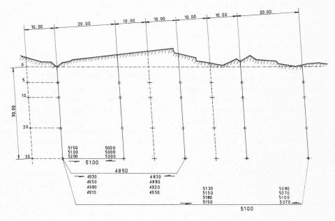
Fig. 7. — Profil étudié par ENEL au voisinage du barrage de Pantano d'Avio. En traits interrompus, forages spécialisés pour l'émission (à explosif). Les résultats des mesures successives sont donnés à titre d'exemple pour quelques trajets seulement.
