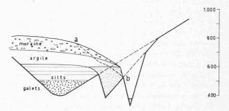
Fig. 3. — Coupe AA sur la figure 2. Dans la zone ab, nombreux ravins creusés dans les alluvions et génant l'interprétation des mesures sismiques.
