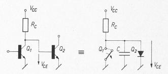
Fig. 7. — Porte DCTL et schéma équivalent pour le blocage.
