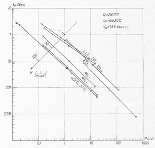
Fig. 4. — Variation du temps de propagation moyen  $t_{pd}$  en fonction de la puissance dissipée par étage P.
