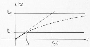
Fig. 8. — Transitoire de blocage du transistor  $Q_1$ .
