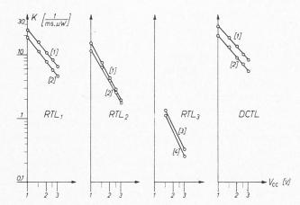
Fig. 5. — Facteur de mérite  $K=1/(t_{pd}\cdot P)$  en fonction de la tension d'alimentation  $V_{CC}$  pour les logiques RTL<sub>1</sub>, RTL<sub>2</sub>, RTL<sub>3</sub> et DCTL.
