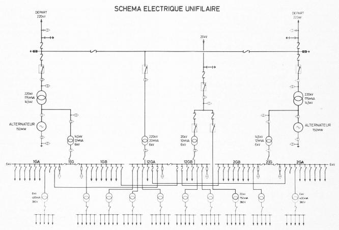
Fig. 1. — Usine de Chavalon — Schéma électrique unifilaire.
