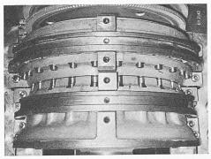
Fig. 11. — Les diaphragmes sont boulonnés axialement en groupes de deux à trois pour empêcher des inétanchéités entre les étages. Ces paquets sont montés avec un jeu radial et reposent sur la partie inférieure à la hauteur de l'axe, de manière qu'ils puissent se dilater librement tout en restant parfaitement centrés.
