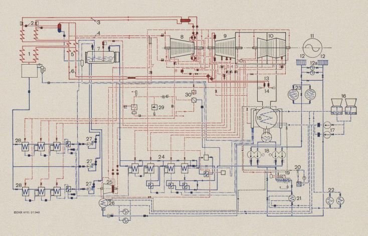
Fig. 7. — Schéma des conduites pour la vapeur vive de 190 kg/cm² à 540°C, le soutirage, l'eau de refroidissement, le condensat, l'eau d'alimentation et l'air.
