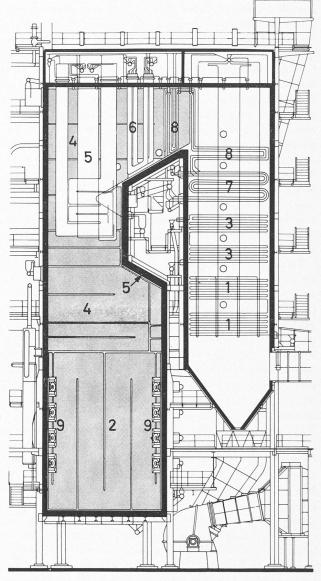
Fig. 5. — Coupe à travers la chaudière monotubulaire de la Centrale de Chavalon.
