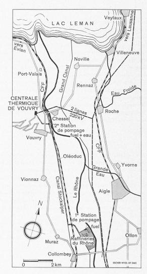
Fig. 1. — Plan de situation de la centrale thermique de Vouvry.
