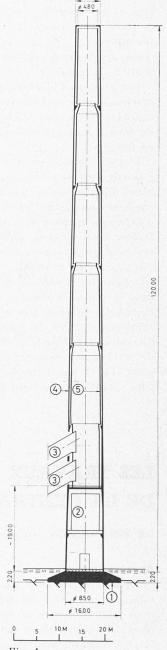
Fig. 1. Cheminée: coupe verticale. 1. Semelle de fondation — 2. Réservoir d'eau 220 m³. — 3. Carneaux. — 4. Manteau en béton armé. — 5. Revêtement intérieur de briques.
