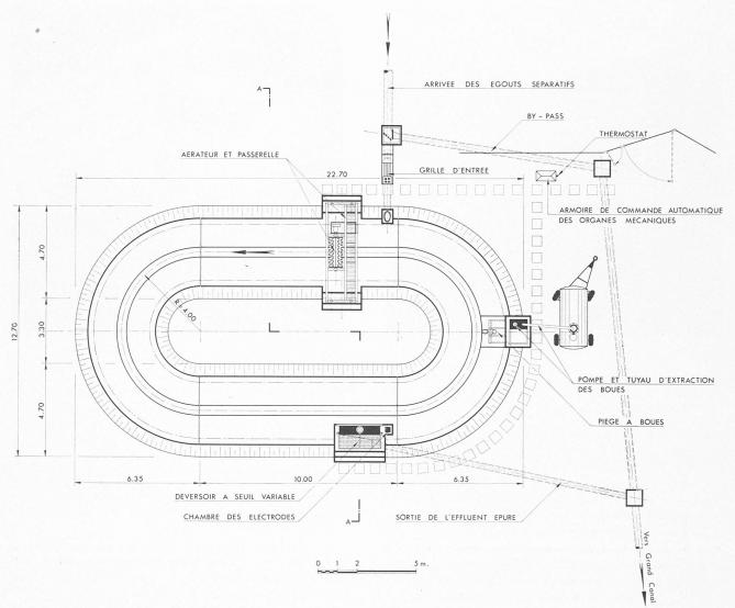
Fig. 2. — Schéma de l'installation en plan.
