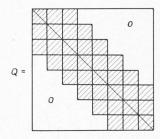
Fig. II.11. — Forme pentadiagonale par blocs de la matrice O.
