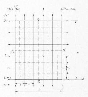
Fig. II.1. — Réseau original et réseau dual.
