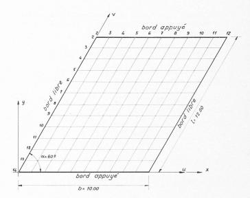
Fig. III.1. — Plan schématique de la plaque étudiée.
