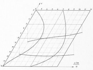
Fig. III.4. — Moments  $M_v$  le long de quelques lignes de coordonnées.
