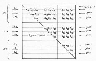
Fig. II.8. — Contribution à la matrice Q d'un domaine du réseau dual.
