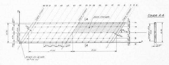
Fig. III.7. — Dalle pont-rail continue - biaise. Plan schématique du modèle (dessin obligeamment prêté par le Laboratoire de statique de l'EPUL).
