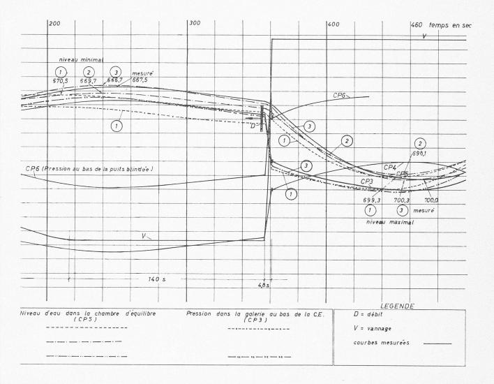
b) La mesure de la vitesse de rotation du groupe montre qu'à la suite d'une fermeture du vannage, il n'y a pas d'augmentation importante de cette vitesse (augmentation de 7,15 à 8 t/s). L'hypothèse admettant une vitesse constante du groupe pendant la fermeture est donc parfaitement justifiable dans le cas de Simmenfluh.
