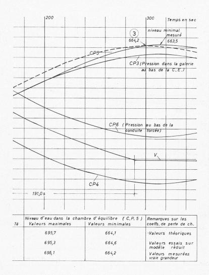
Fermeture du vannage en 4,0 s. suivi aprés 94,0 s. d'une ouverture en 191,0 s.
