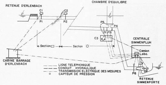
Fig. 2. — Schéma général des dispositifs de mesure.
