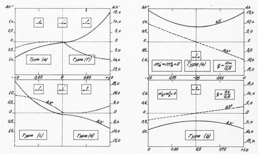
Fig. 6. — Pertes de charge dans le raccordement en té de Simmenfluh.
