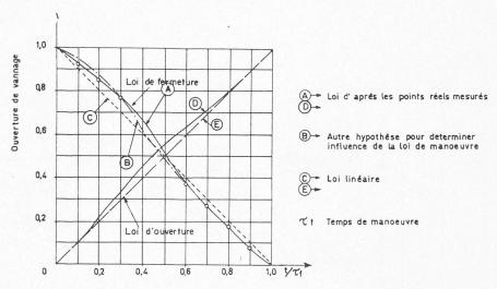
Fig. 9. — Lois de manœuvre du vannage.
