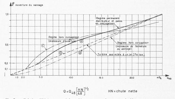
Fig. 7. — Relation débit/ouverture à la turbine pour une chute nette de 48 m.
