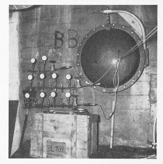
Fig. 3. — Chambre de mesures C3 avec les trois capteurs de pression CP3, CP4 et CP5 et les manomètres de contrôle montés sur chacun des raccords aux prises de pression.
