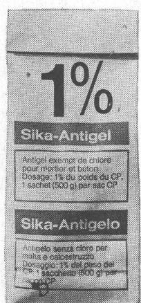
Pour cela, il faut prendre FRIOLITE oC ou SIKA-ANTIGEL. Avec un minimum d'eau de gâchage, la chaleur nécessaire à la prise normale et à un accroissement rapide des résistances se dégagera au cours de la réaction avec le mélange de bétonnage. Avec Sika-Antigel, vous pouvez bétonner sans aucun risque jusqu'à -10 °C, avec FRIOLITE oC même jusqu'à -15 °C.
