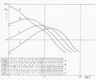
Fig. 1. — Influence de la résistivité du terrain de surface sur les courbes de sondage électrique.
