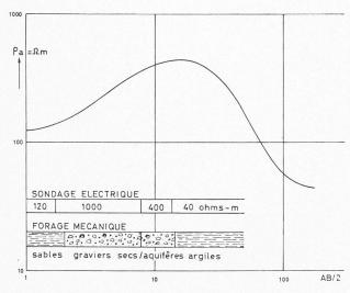
Fig. 3. — Sondage électrique « hydrologique ».
