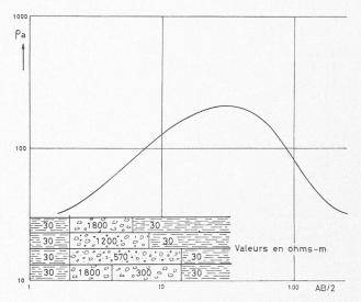
Fig. 2. — Illustration du principe d'équivalence.
