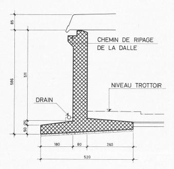
Fig. 2. — Coupe du mur-culée. Système classique.
