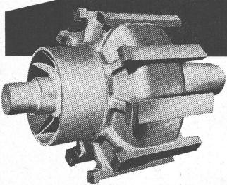
Rotor coulé en 2 parties, assemblées par soudage Poids 380 kg sont tirés à 75 km/h par les locomotives Ae 6/6 sur les rampes du Gotthard (pente: 27 º/oo). Les rotors des moteurs de ces locomotives sont, de ce fait.
