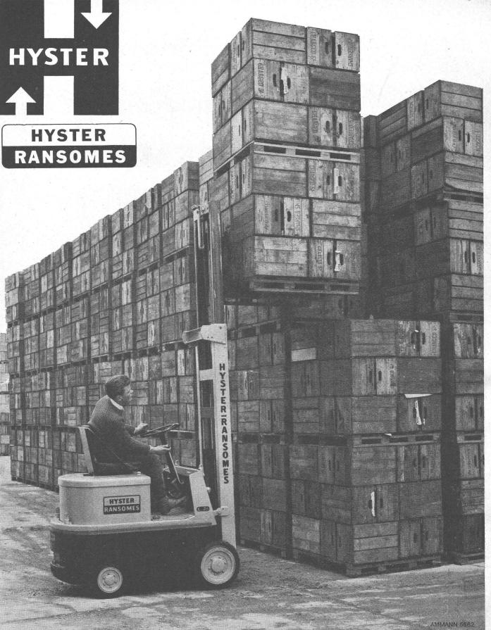
Chariots-élévateurs électriques HYSTER-RANSOMES, capacité 500 kg à 3500 kg.
