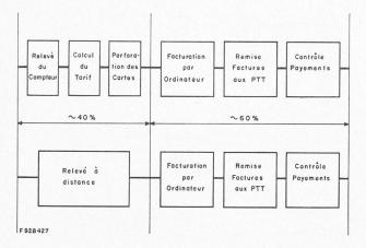
Fig. 19 — Comparaison schématique de la lecture traditionnelle et de celle à distance de compteurs. Les pour-cent indiquent la répartition des frais selon les groupes d'opéra-
