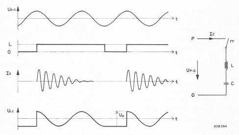
Fig. 10 — Formation d'une oscillation amortie à fréquence audible par enclenchement sur le réseau d'un circuit série
