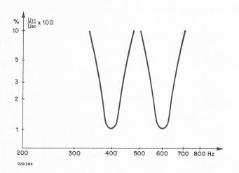
Fig. 2 — Courbes de sélectivité de récepteurs de télécommande centralisée
