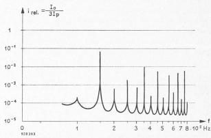
Fig. 6 — Courant relatif dans le neutre en fonction de la fréquence, le courant étant rapporté à la somme des courants 50 Hz de phase
