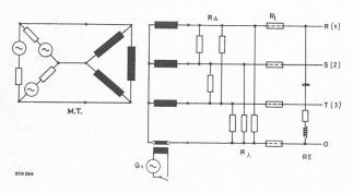
Fig. 3 — Installation de télécommande centralisée avec injection monophasée au secondaire d'un transformateur de distribution
