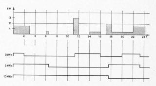
Fig. 20 — Représentation d'une courbe de consommation moyenne avec la position du commutateur pour différentes valeurs de la quantité fixe choisie
