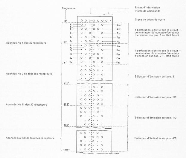
Fig. 15 — Exemple d'un ruban perforé pour une installation METRAGYR comportant 30 récepteurs
