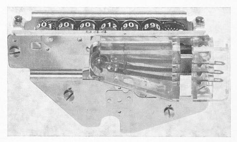
Fig. 8 — Minuterie à tambours avec contact commutateur
