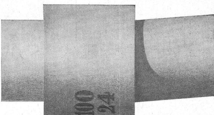
Les joints, coudes et pièces moulées en amiante-ciment présentent de grands avantages techniques et économiques dans la pose de conduites sous pression et de canalisations. Les jonctions sont lisses. Les joints permettent une déviation allant jusqu'à 3°.
