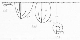
Fig. 1. — Figures de rupture d'écrans enterrés.
