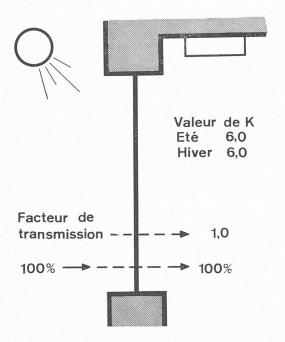
Fig. 9. — Transmission dans le cas du verre simple.
