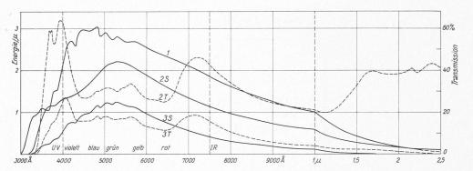
Fig. 8. — Mesures de transmission à travers des vitres «Thermopane» et «Stop-Ray», à l'aide d'un photomètre spectral Zeiss PMQ II.
