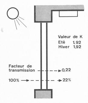
Fig. 13. — Transmission dans le cas du « Stop-Ray ».
