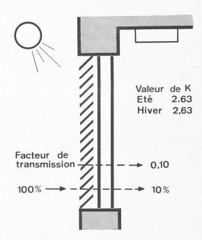
Fig. 12. — Transmission dans le cas «Thermopane» et persiennes à l'extérieur.
