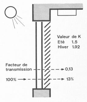
Fig. 14. — Transmission dans le cas « Stop-Ray » et persiennes à l'intérieur.
