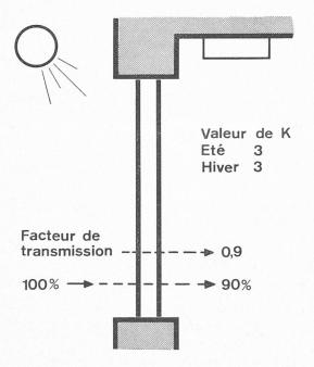
Fig. 11. — Transmission dans le cas du double vitrage.
