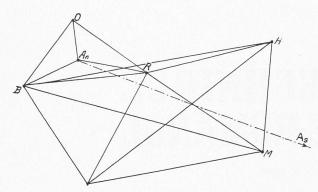
Fig. 1. — Fragment du réseau du tunnel du Simplon.
