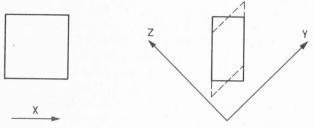
Fig. 13. — Cisaillement d'épaisseur.
