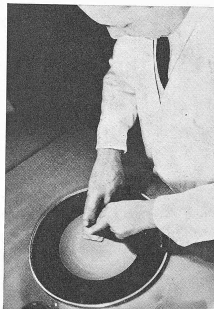
Fig. 24. Rodage au tour d'opticien.
