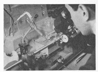
Fig. 29. — Soudure des connexions sur le quartz.
