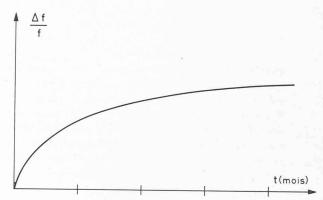
Fig. 17. — Vieillissement du quartz.
