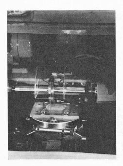
Fig. 26. Tronçonnage des barreaux.
