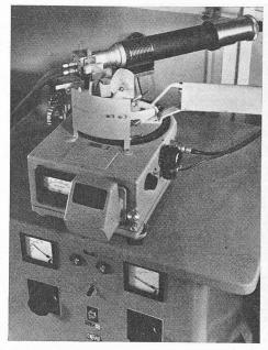
Fig. 23. Goniomètre à rayons X.
