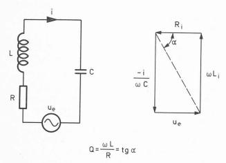
Fig. 5. — Entretien des oscillations d'un circuit électrique.
