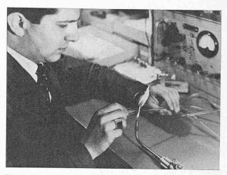
Fig. 34. — Scellement des ampoules.
