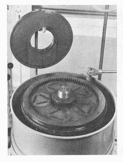
Fig. 27. Machine à roder les surfaces.
