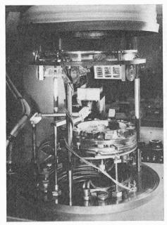
Fig. 28. Machine à évaporer sous vide.
