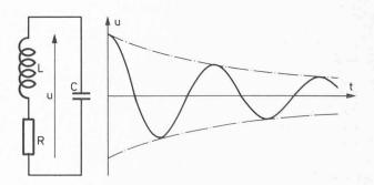
Fig. 3. Circuit oscillant avec pertes.
