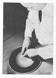
Fig. 24. Rodage au tour d'opticien.
