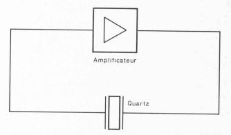
Fig. 15. — Oscillateur à quartz.
