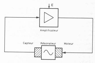
Fig. 7. — Oscillateur, configuration générale.
