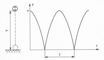
Fig. 1. — Mouvement d'une bille rebondissant sur un plan élastique.
