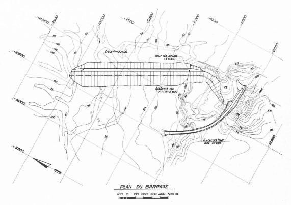
Fig. 1. — Disposition générale du barrage Pinios.
