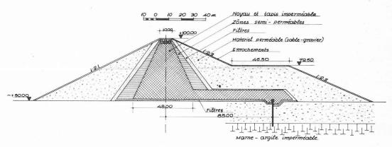
Fig. 2. — Coupe transversale du barrage Pinios.
