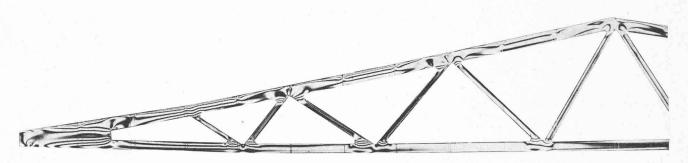
Fig. 4. — Modèle  $M_1$ : lignes isochromes. ( $\sigma 1 - \sigma 2 = \text{cte}$ ). Cas de charge II fig. 2.
