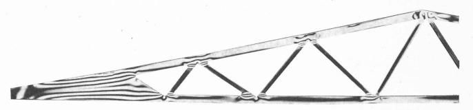
Fig. 8. — Modèle  $M_1$ : lignes isochromes. ( $\sigma 1$  —  $\sigma 2$  = cte). Cas de charge I fig. 2.
