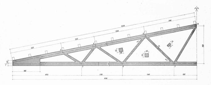
Fig. 3. — Dimensions géométriques de l'ouvrage.
