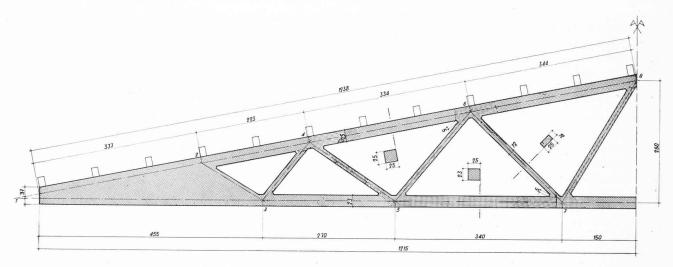
Fig. 7. — Dimensions géométriques de l'ouvrage.
