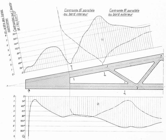
Fig. 6. — Modèle M<sub>2</sub>. Cas de charge III fig. 2. Contraintes sur l'ouvrage.
