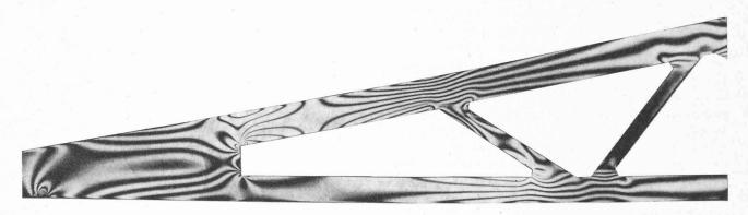
Fig. 5. — Modèle  $M_2$ : lignes isochromes. ( $\sigma 1 - \sigma 2 = cte$ ). Cas de charge III fig. 2.
