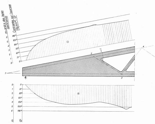
Fig. 9. — Modèle M2. Cas de charge III fig. 2. Contraintes sur l'ouvrage.
