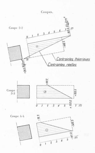
Les mêmes constatations peuvent être faites sur une photographie de la poutre soumise au cas de charge I de la figure 2. En confirmation du calcul classique, les diagonales ne subissent aucun effort, sauf la diagonale 2-3 qui est soumise à un moment fléchissant. L'examen qualitatif des photographies d'ensemble de la poutre nous permet de résumer son comportement par le schéma suivant:
