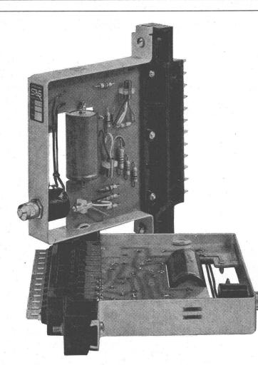
Système de commande à relais statiques pour applications industrielles de Sprecher & Schuh
