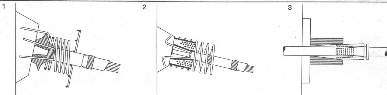
Les diverses unités Freyssinet de précontrainte — monofils jusqu'à 12 t, câbles à 12 fils jusqu'à 67,5 t, câbles à 12 torons jusqu'à 200 t — sont munies d'ancrages adaptés à chaque type. Mais tous ont un trait commun: une simplicité remarquable qui tient compte des conditions réelles régnant sur les chantiers et permet un travail accéléré.
