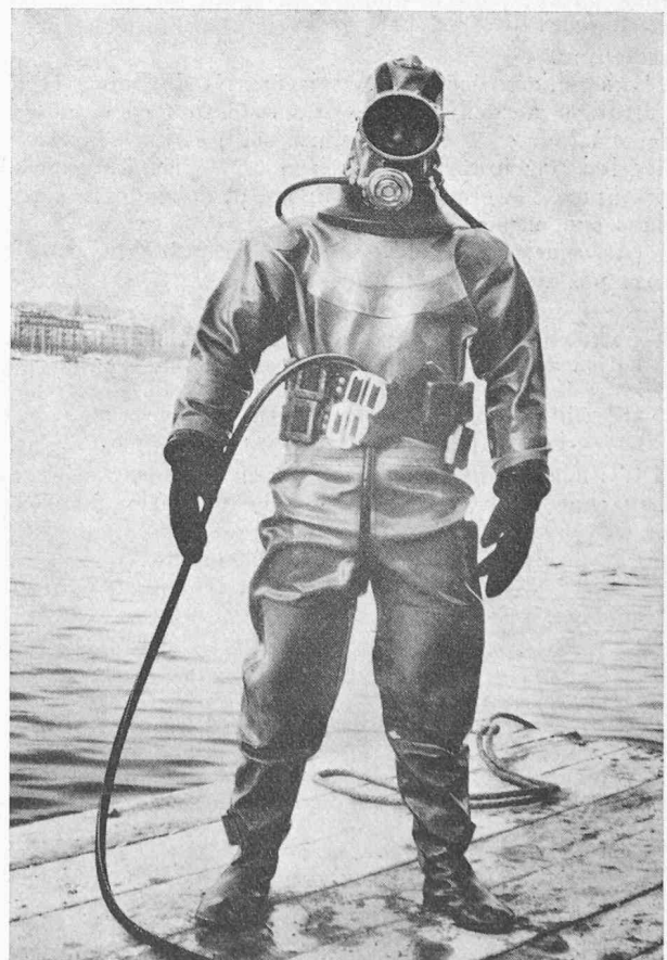
Fig. 13. — Plongeur équipé d'un vêtement étanche à volume constant utilisé dans les eaux froides ou polluées. Alimentation en air basse pression par narguilé relié au compresseur de surface.
