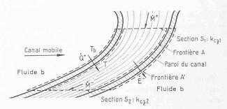
Fig. 4.3. — Canal mobile, traversé par un fluide en régime permanent et échangeant de la chaleur avec un fluide b.
