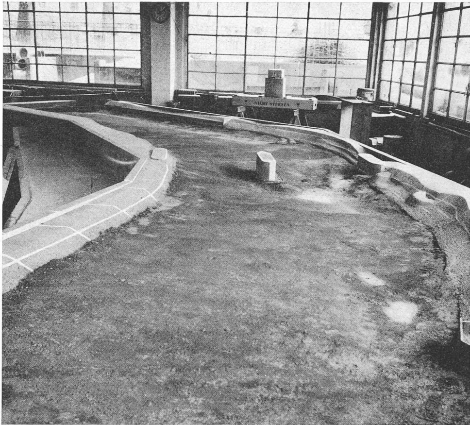
Fig. 8. — Maquette du passage au pont Butin, échelle 1/35, vue de l'amont. Au milieu de la photo, les trois piles du pont. La berge gauche en amont du pont a déjà été corrigée et l'approfondissement de la passe gauche exécuté. Cette situation est celle qui figure sur la photo stroboscopique (fig. 10).
