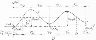
Fig. 5 a, b, c. — Courbes représentant la surpression p, le déplacement radial u et la tension  $\sigma$ , en fonction du temps t, dans le cas où les vibrations sont produites par un accroissement subit de la pression intérieure, qui reste ensuite constante.
