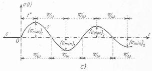
Fig. 4 a, b, c. — Courbes représentant la surpression p, le déplacement radial u et la tension  $\sigma$ , en fonction du temps t, dans le cas d'une percussion intérieure P.
