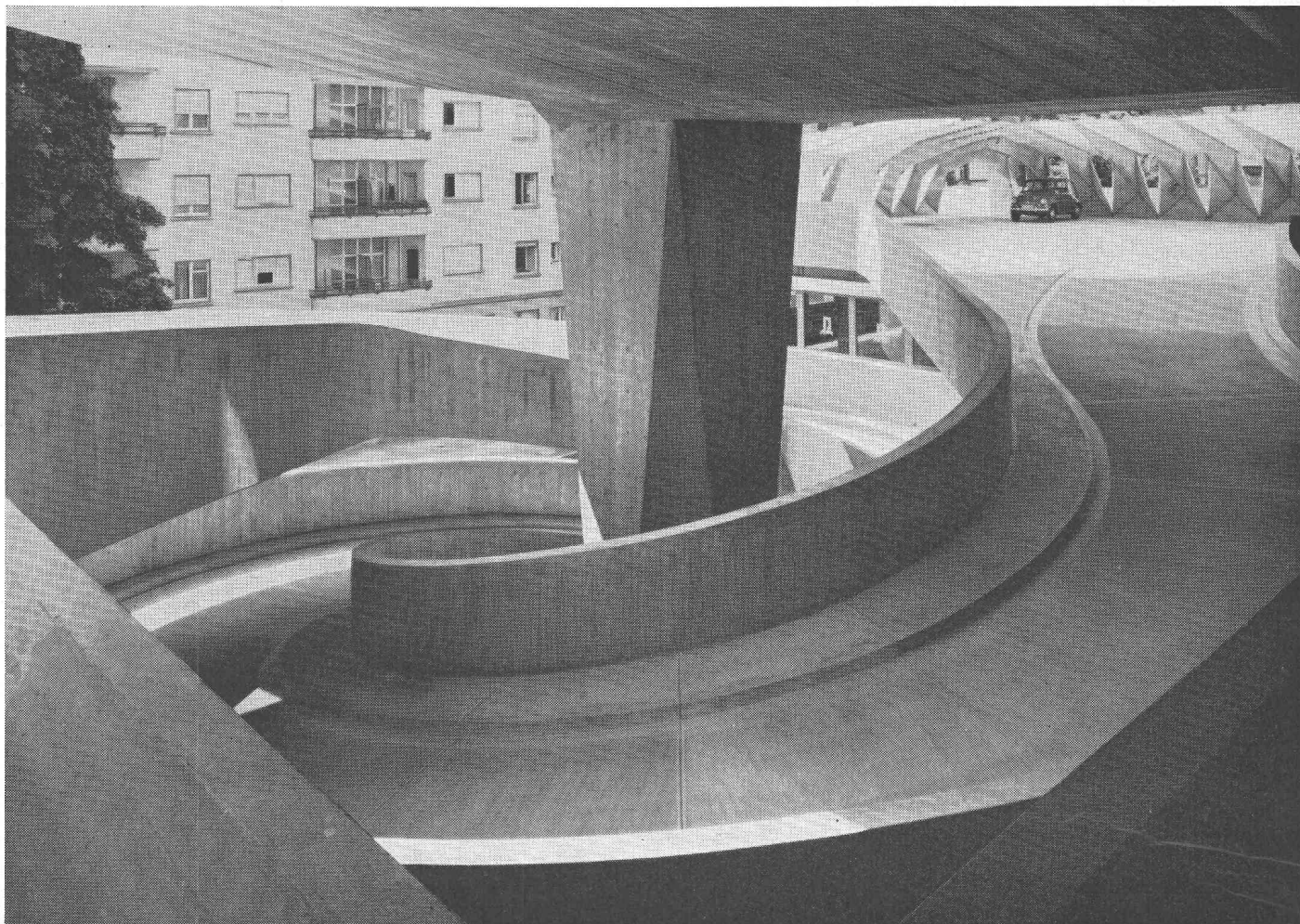
Rampe d'accès de la maison-tour « zur Palme » à Zurich. Chape en béton dur Korodur, exécutée par l'entreprise Hein. Hatt-Haller S. A. à Zurich.
