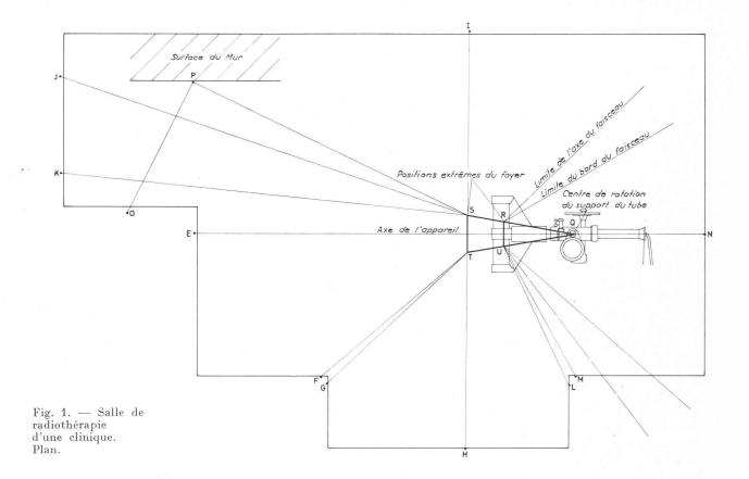
faisceau, dans le plan horizontal passant par le foyer, sont indiquées sur la figure.
