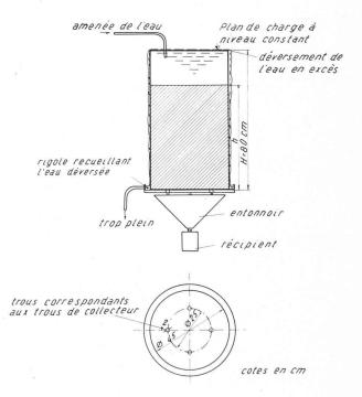
Fig. 2. — Appareil de mesure de la perméabilité des filtres pour drainage. Coupe verticale selon l'axe et vue de la plaque de base.
