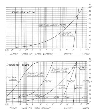
Fig. 4. — Courbes granulométriques des matériaux utilisés comme filtres.
