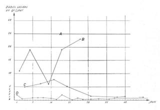
Fig. 6. — Débit solide à la sortie des filtres en fonction du temps.
