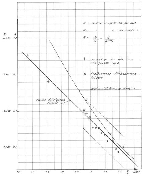
Fig. 6. — Courbe d'étalonnage du nucléodensimètre.
