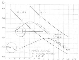
Fig. 9. — Résultats de deux séries de mesures effectuées au nucléodensimètre sur les chantiers de l'autorouteGenève-Lausanne comparés à ceux des essais de compactage Proctor correspondants.
