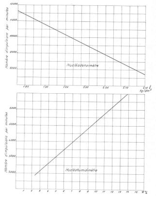
Fig. 8. — Courbes d'étalonnage du nucléodensimètre et du nucléohumidimètre.
