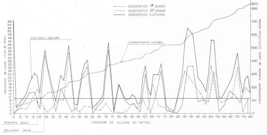
coulis étaient les mêmes que précédemment C/S=2:1 à 1:1, avec C/E=2:1 pratiquement constant. Le traitement jusqu'au km 0.143.50 a duré 37 jours. Les résultats obtenus sont donnés sur la figure 4, avec une absorption moyenne de 4.03 t/m forage ou 38.38 t/m de galerie pour une longueur de creusement de 50 m.
