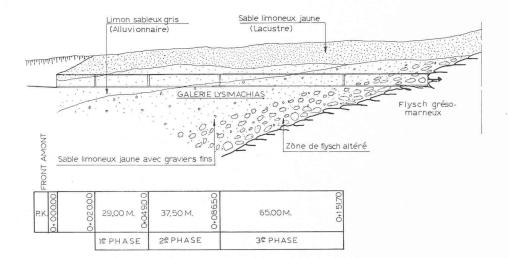
A la fin de ce traitement complémentaire, le creusement a pu être poursuivi sans difficulté jusqu'au km 0,931 en calotte (et 0,928 au piedroit) par tranches de 3 m, comme précédemment, et dans des conditions normales, en tout cas jusqu'au km 1,190.
