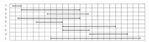
Fig. 2. — Excavation de l'ensemble chambre d'équilibre d'amont - centrale - galerie de fuite. Succession des opérations.
