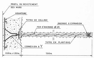
Fig. 7. — Boulons d'ancrage.
