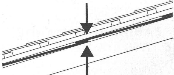
Le maître couvreur recommande la soustoiture ETERNIT, élément nécessaire du toit. Les plaques d'amiante-ciment ETERNIT et GEA en augmentent le pouvoir isolant. Elles forment une couverture étanche aux poussières, à la pluie, à la neige et à l'eau de fonte de celle-ci. Incombustibles, elles diminuent le danger d'incendie. La pose de la soustoiture ETERNIT est simple et rapide.
