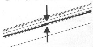
Le maître couvreur recommande la soustoiture ETERNIT, élément nécessaire du toit. Les plaques d'amiante-ciment ETERNIT et GEA en augmentent le pouvoir isolant. Elles forment une couverture étanche aux poussières, à la pluie, à la neige et à l'eau de fonte de celle-ci. Incombustibles, elles diminuent le danger d'incendie. La pose de la soustoiture ETERNIT est simple et rapide.
