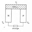
T<sub>1</sub> = température supérieure T<sub>0</sub> = température inférieure N.Pe semi-conducteur type N., resp. P
