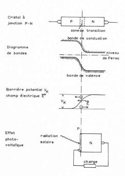
Fig. 4. — Principe physique de la batterie photo-électrique.
