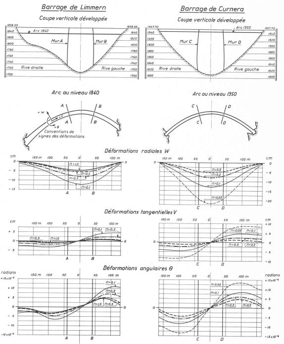
Fig. 2. — Influence du module d'élasticité de la fondation sur les déformations d'un barrage-voûte. Déformations d'un arc voisin du couronnement.
