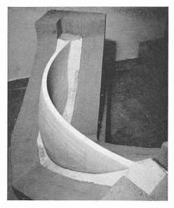
Fig. 6. — Barrage de Limmern. Modèle en plâtre taillé. Echelle 1:250. (Photo de Jongh, Lausanne)
