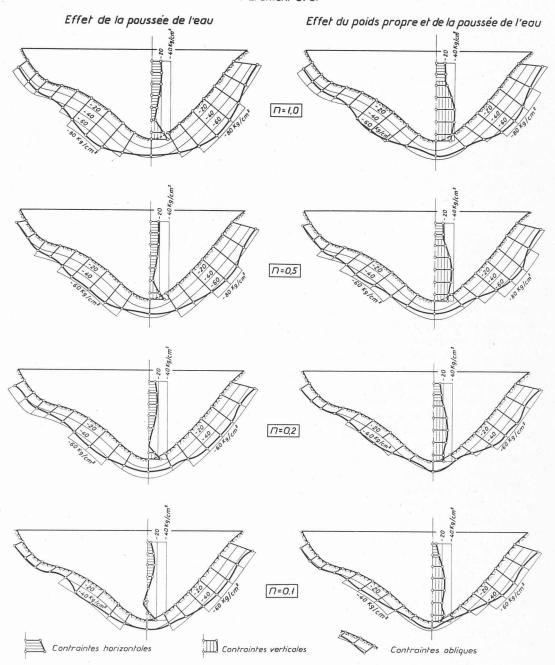
Fig. 4. — Influence du module d'élasticité de la fondation sur les contraintes dans un barrage-voûte. Parement avail du barrage de Limmern, n=1 à 0,1. Contraintes principales le long de la fondation et le long de la section de clé. (Le signe — correspond à la compression.)
