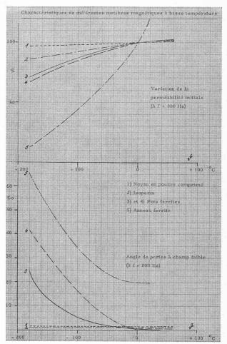
Fig. 5. — Perméabilité et angle de pertes en fonction de la température pour différentes matières magnétiques à  $f=800~\mathrm{Hz}$  et à champs faibles.
