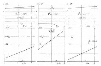
Fig. 2. — Tore en ferrite. Perméabilité et angle de pertes à  $800~\mathrm{Hz}$  à champs faibles.
